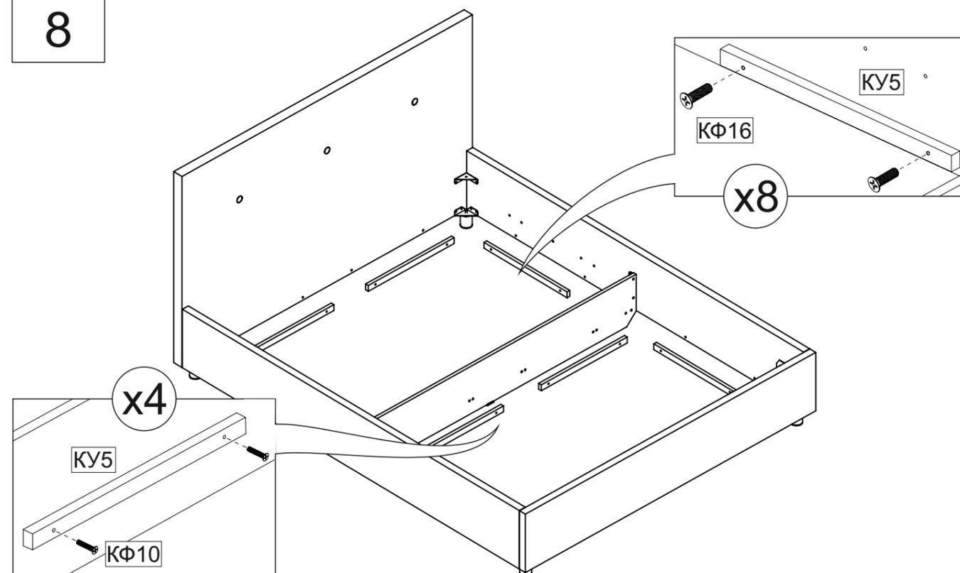
Упоры для дна КУ5 можно установить до соединения царг и изголовья. Для распорки КО4 используется винт КФ10 (М6х30), для всего остального - КФ16 (М6х35).
