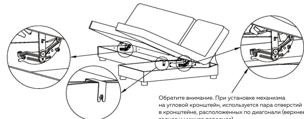
Обратите внимание. При установке механизма на угловой кронштейн, используется пара отверстий в кронштейне, расположенных по диагонали (верхнее заднее и нижнее переднее)
