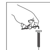
Дорогие покупатели! Очень важно сначала наживить винт вручную и сделать пару оборотов, чтобы он правильно встал, и только потом закручивать шестигранником!
